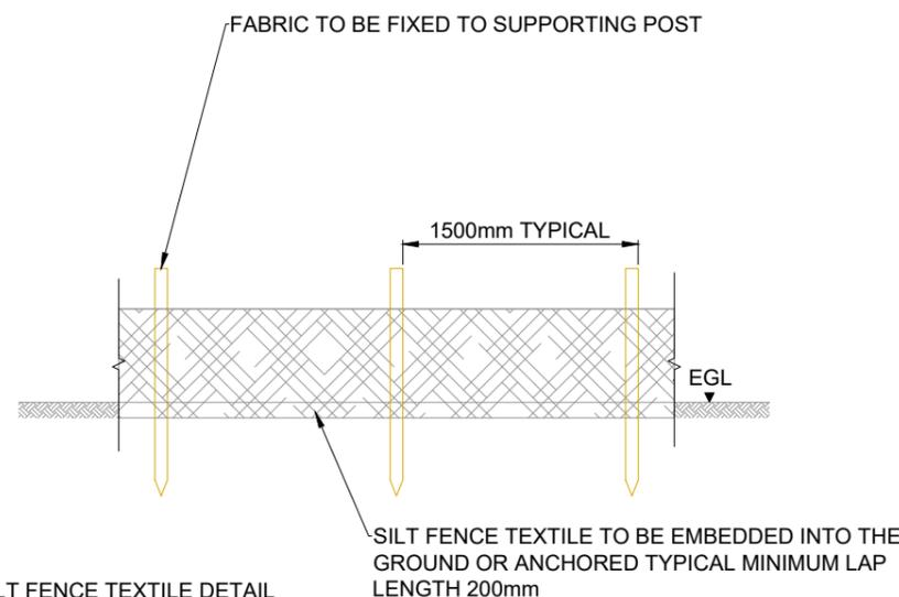
**SILT FENCE TEXTILE DETAIL**
