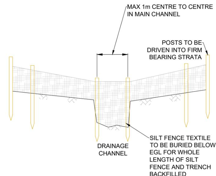
**TYPICAL CHANNEL SILT FENCE ELEVATION**
