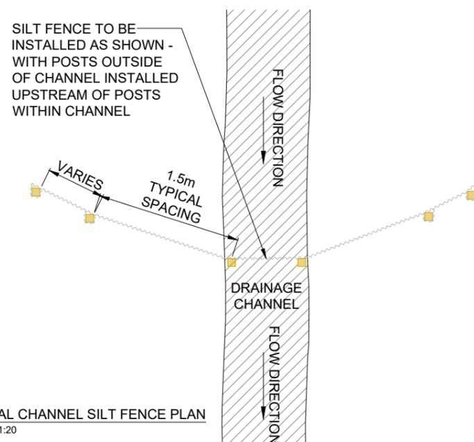
**TYPICAL CHANNEL SILT FENCE PLAN**
